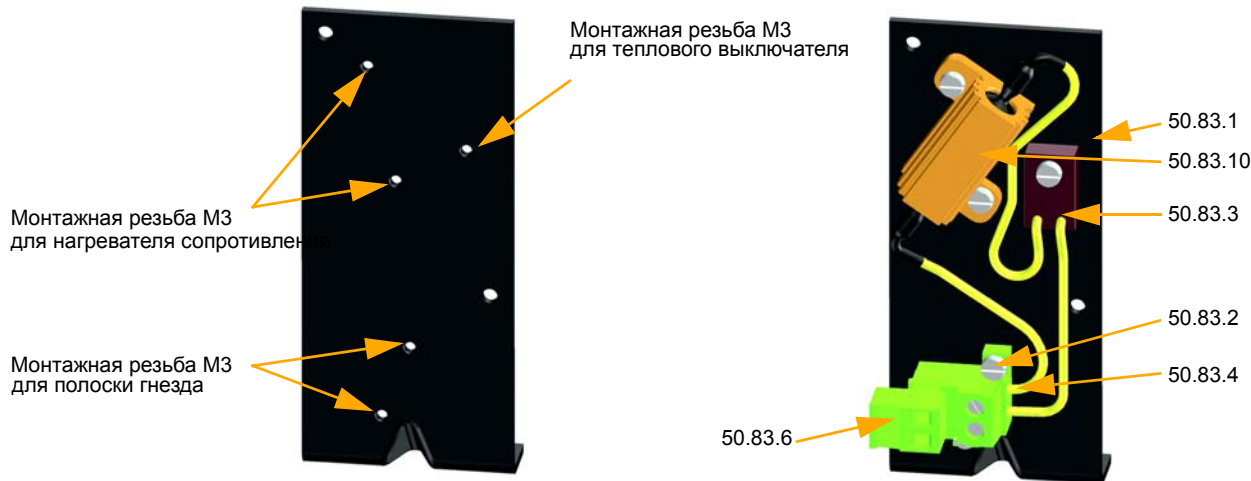
Fig. 25: Монтаж системы обогрева ARI-PREMIO 2.2-15 кВт
