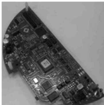
Плата интерфейса с Fieldbus Тип платы зависит от шины Fieldbus, имеющейся на объекте.
