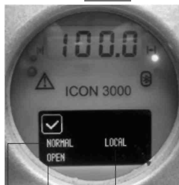
Состояние Запрос функционирования или положения R% Положение локального переключателя
