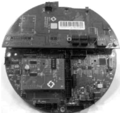
Вид основной платы сверху Основная плата оснащена платой интерфейса Fieldbus и платой переходника клемной колодки.
