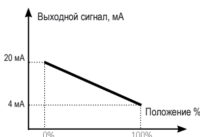
ВЫХОД: КРУТЯЩИЙ МОМЕНТ ПОЛЯРНОСТЬ: 4 мА = ОТКРЫВАНИЕ
