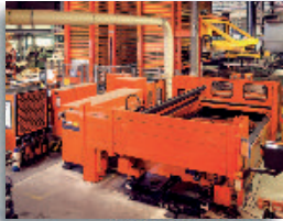
Laserschneidanlage Präzise Einzel- und Kleinserienfertigung.
