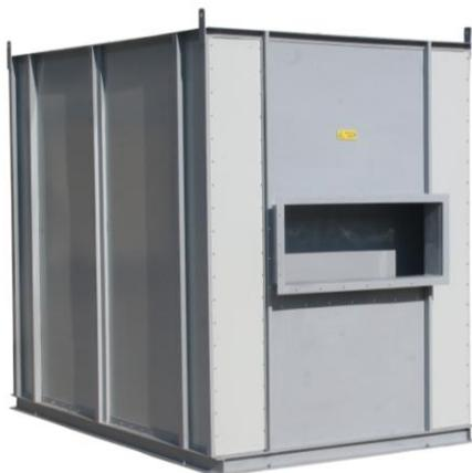
Адсорбционный слой для очистки воздуха от газообразных токсичных веществ состоит из насыпного слоя гранульных сорбентов: (активированный уголь, хемосорбенты) и слоев волокнистых ионообменных фильтро-материалов. Высота сорбционного слоя рассчитывается в соответствии с технологическими требованиями (требуемое время контакта, объем воздушного потока, перепад давления и т.п.).
