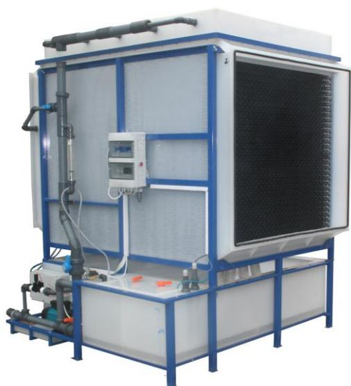
**Фильтры ФК-ИС** – это высокоэффективные контакторные фильтры селективной окислительной абсорбции (хемосорбции). В основе селективной окислительной абсорбции лежат окислительно-восстановительные процессы, в результате которых поглощаемые токсичные вещества превращаются в нейтральные и безопасные соединения.
