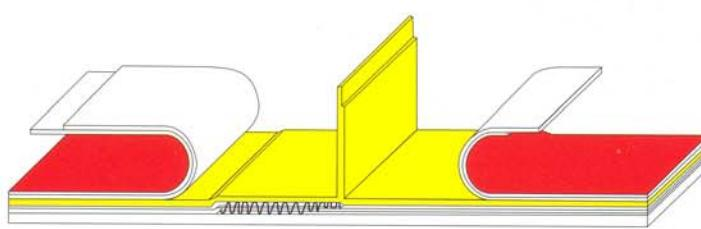
Закрытие изолирующей фольги требует особой тщательности. Сначала оба конца фольги подгоняются друг к другу. Более длинный конец фольги заворачивается на короткий, а потом оба конца крепко сворачиваются в скатку и укладываются на нижележащие слои.
