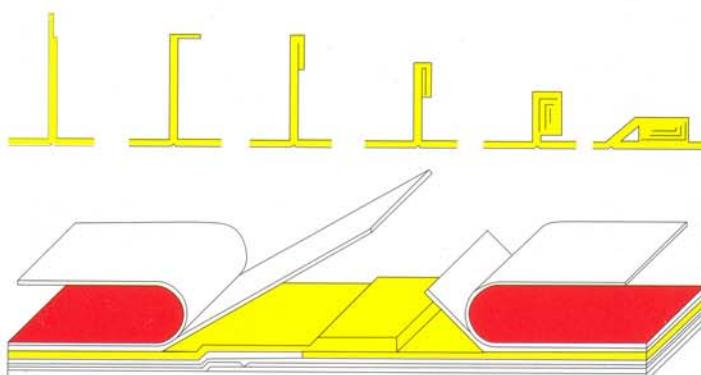
В зависимости от конструкции после изолирующей фольги могут следовать 1 или 2 слоя ткани, концы которых накладываются друг на друга и склеиваются.
