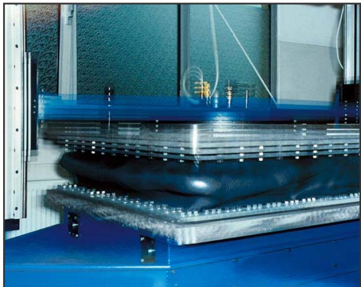
В 1981 году в сотрудничестве с TÜV Essen нами были утверждены «Требования к испытаниям». На специальном испытательном стенде воспроизводятся различные условия эксплуатации: температура, давление и перемещения компенсатора. Такие испытания обязательно применяются к компенсаторам, устанавливаемым на АЭС. Эти испытания всегда выявляют высокое качество производства и отличную работу системы контроля качества.
