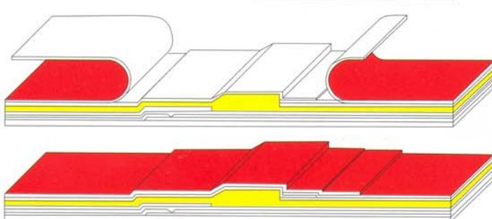
Готовый замкнутый стык изолируется тем же материалом, что и покрытие на последнем слое ткани (напр. силиконовый каучук). При наружном покрытии из тефлона (PTFE-Glastex) замыкание стыка проводят аналогично операциям с уплотнительной фольгой (см. выше).
