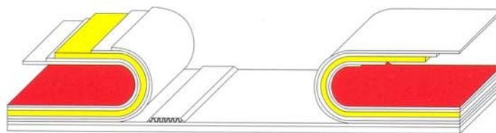
Слои ткани накладывают друг на друга и склеивают. При температурах выше  $250^{\circ}\text{C}$  слои сшиваются.
