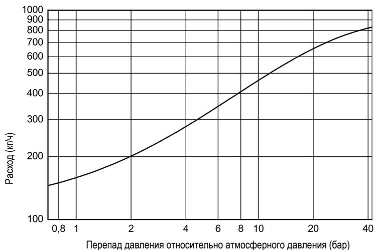
Диаграмма иллюстрирует максимальную пропускную способность горячего конденсата для регуляторов в стандартном исполнении.
