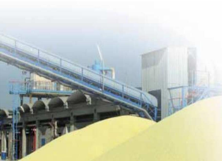
При работе 24 часа в сутки и производительности до 12 тонн в час эта установка может обрабатывать до 288 тонн серы в день.
