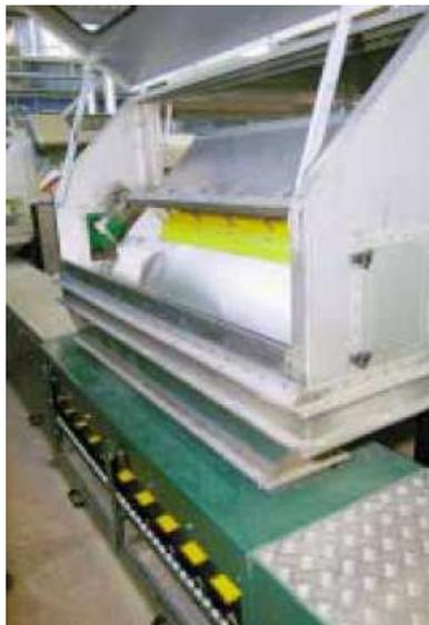
Разгрузочный узел конвейера-охладителя
