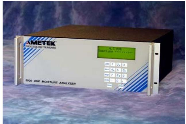
частота колебаний кристалла возрастает. Разность между "влажной" и "сухой" частотой пропорциональна содержанию воды в газе. Периодичность переключения потоков составляет 30 с, т. е. полный цикл измерения составляет одну минуту.
