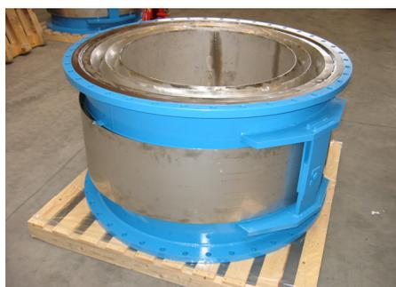
Этот компенсатор используется для производства карбоновой сажи. Сажа производится при очень высокой температуре. Чтобы снизить нагревание, трубы, как правило, замуровываются. Наш компенсатор разработан таким образом, что проводящая среда не входит в контакт с чувствительным сильфоном, а потому предотвращает его перегревание.
