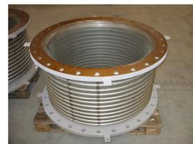
Перфорированный патрубок установлен в компенсаторе с внутренней стороны и служит для предотвращения турбулентности, которая может возникнуть в проводящей среде.
