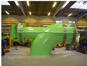
2 подобных компенсатора разработанны для паровой турбины в Сингапуре. Компенсаторы установлены между турбиной и конденсатором.
