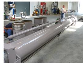
Длина этого компенсатора составляет 9 м. Установлен на заводе по рафинированию нефти в Австрии.
