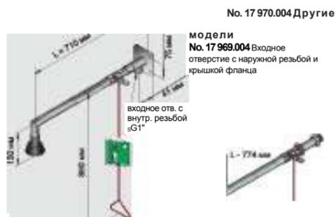
Модульный душ для тела для свободного крепления на стену с тяговым рычагом и самоосушаемой головкой.
