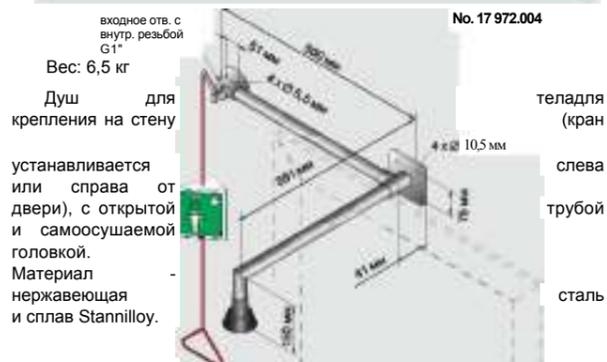
Душ для крепления на стену устанавливается слева или справа от двери, с открытой и самоосушаемой головкой.
