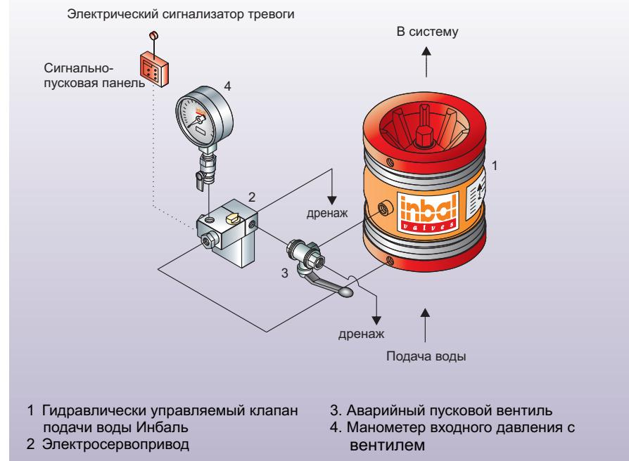
замедляя открытие и (или) закрытие узла управления клапана **Инбал**. Такие функции обычно требуются при довольно большой протяженности трубопровода и (или) при его расположении под наклоном вниз, когда существует опасность гидравлического удара вследствие резких изменений скорости потока воды.
