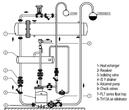
Отвод конденсата из систем под вакуумом (мин.0,2 бар абсолютного давления).
