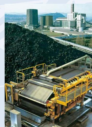
Фильтрпресс фирмы Андритц типа CPF в процессе обогащения угля
