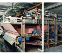
Для обработки низковязких слабоконцентрированных шламов машина PowerPress может быть выгодно дополнена гравитационным столом (верхнее или последовательное расположение).
