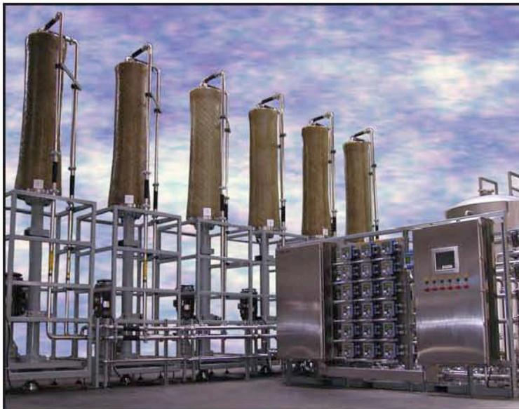
Шести- модульная i84 VSEP Наночисточная мембранная система
