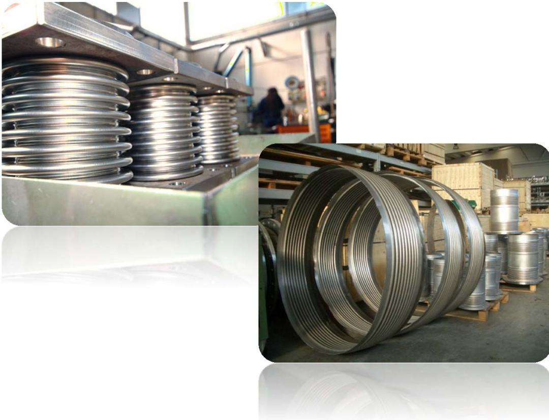
Трубы подвергаются деформации из-за разницы температур, давления, внешнего движения и массы самих труб. Там, где значения этих усилий и движения превышают нормы, нужно устанавливать компенсаторы, которые сделают расширения труб безопасными.
