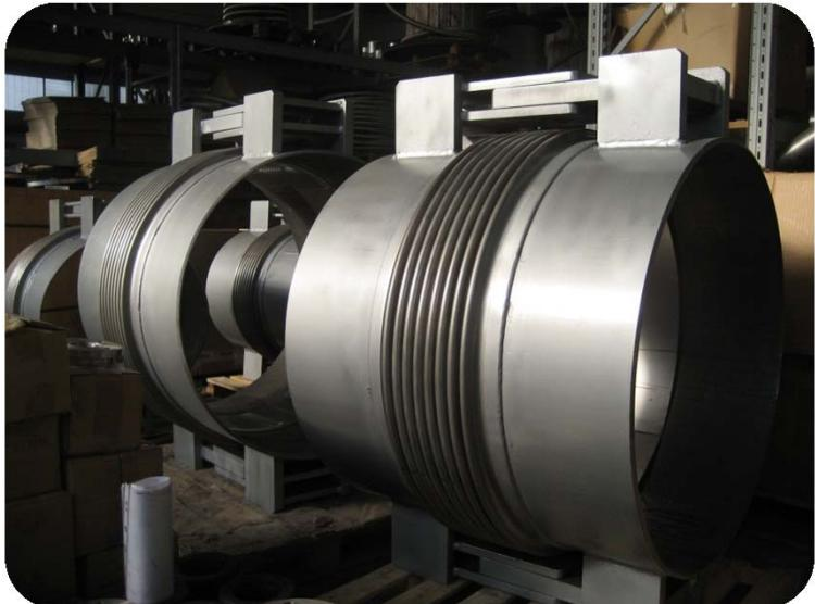
Компенсаторы классифицируются в соответствии с деформацией, которую они компенсируют, следующим образом
