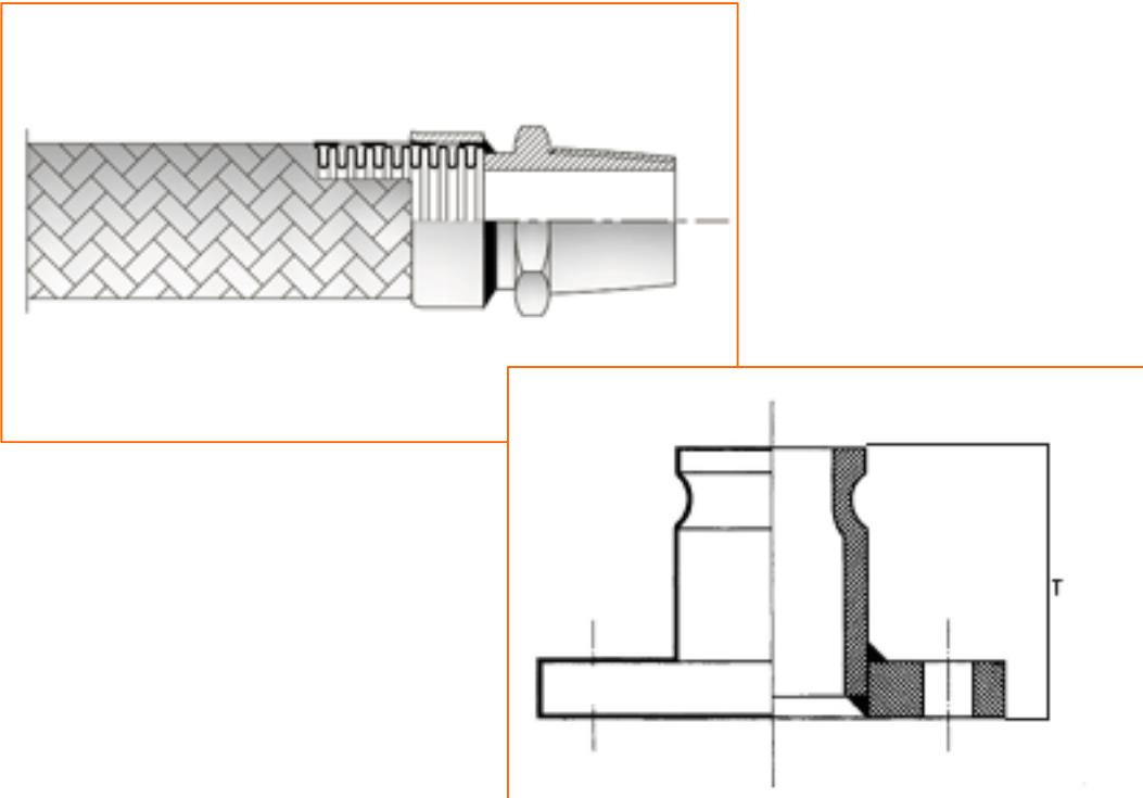
Каждый гибкий шланг может быть оснащен различными фитингами из любых доступных на рынке материалов. Фитинги для шлангов могут быть выполнены сваркой из серебряного сплава или газовольфрамовой сваркой. Последняя имеет очень высокую устойчивость к высоким температурам, до 800°C, тогда как серебряный сплав выдерживает температуру до 300°C. Быстрое подсоединение фитингов обеспечивает безопасное соединение без утечек между двумя элементами.
