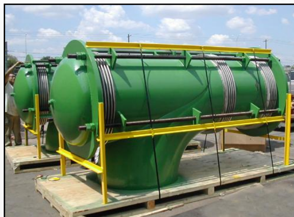
Разгруженные компенсаторы для избыточного давления 50 PSIG и 450°F для линии размером 42"
