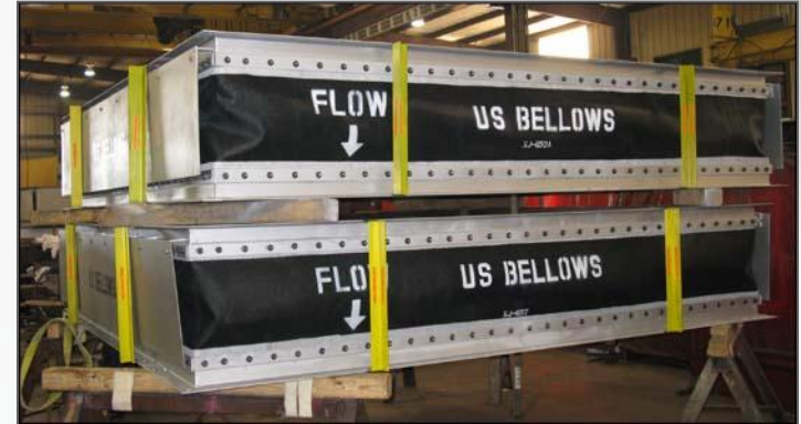
10' Квадратный тканевый компенсатор для высоких температур
