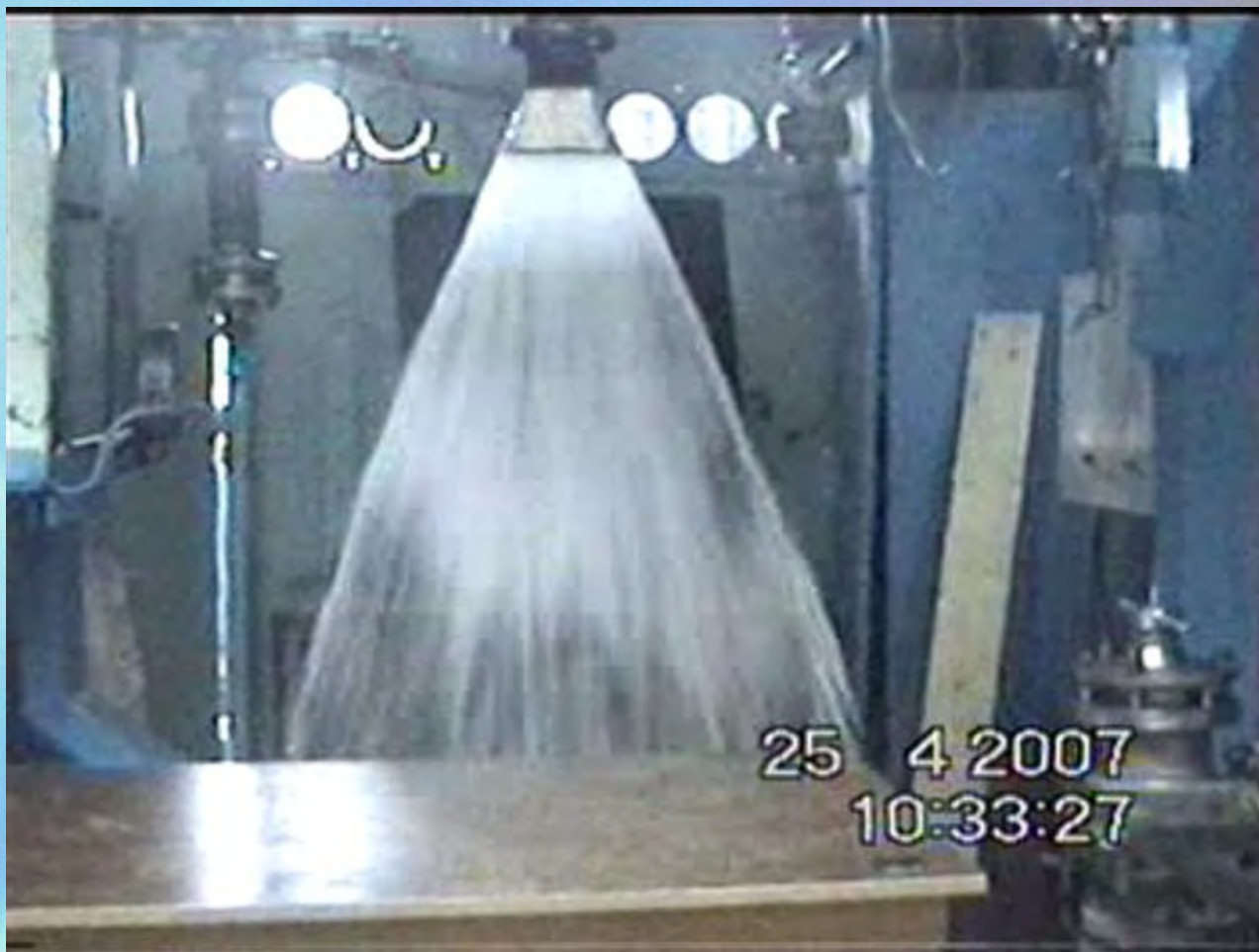
Проливка сырьевой форсунки реактора каталитического крекинга
