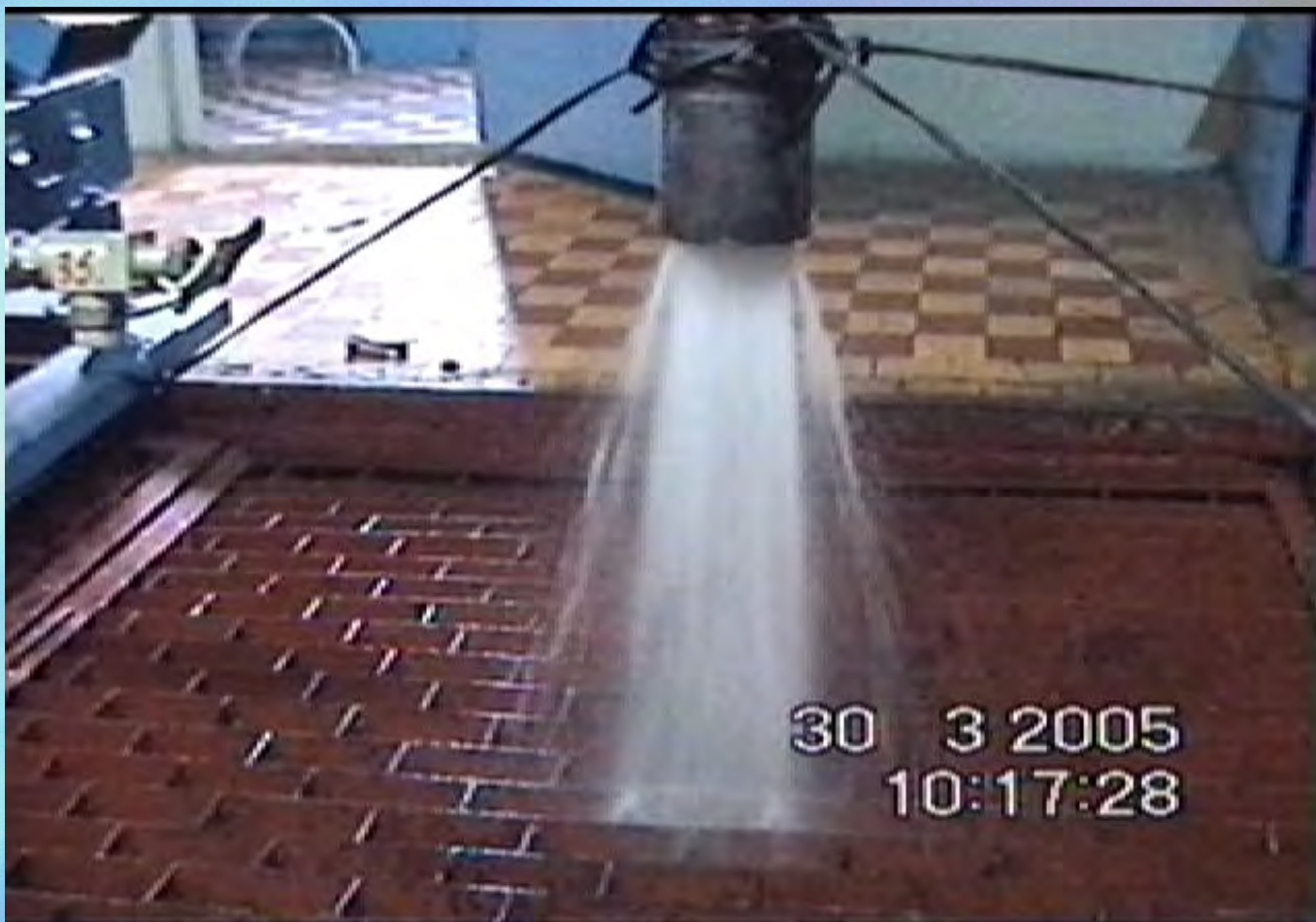
Проливка сырьевой форсунки реактора каталитического крекинга
