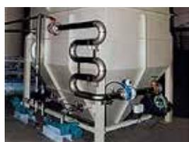
**Пластинчатый седиментационный осветлитель.** Применяется на стадии физико-химической водоочистки стока для разделения осветленной очищенной воды от химически-связанных реагентами загрязнений.
