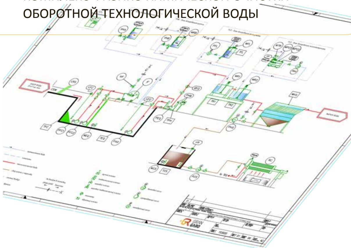
Полный комплекс физико-химической водоочистки оборотной технологической воды для предприятий по переработке вторичных пластмасс.
