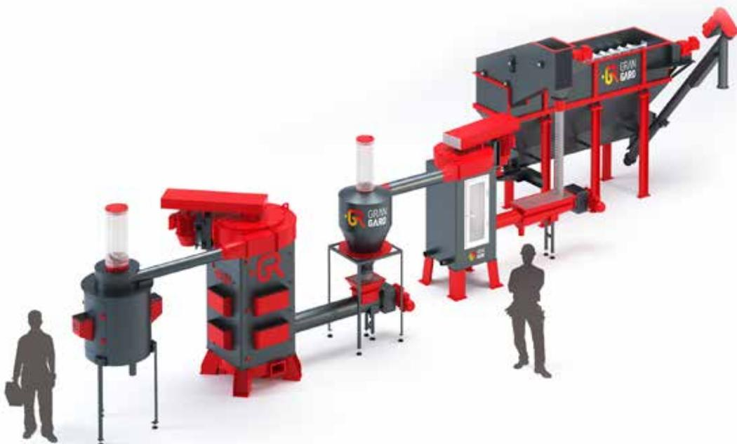
Моечно-сушильная линия GRANGARO для переработки твердых (не пленочных) пластмасс (флаконы/бутылки/канистры/ёмкости ПНД, ПВД, ПП, ПЭТ). Предназначена для очистки загрязнённого сырья, включая полигонное.
