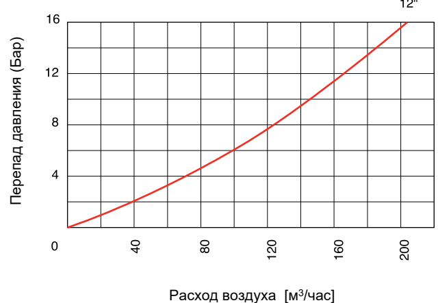
Расход воздуха при автоматическом сбросе
