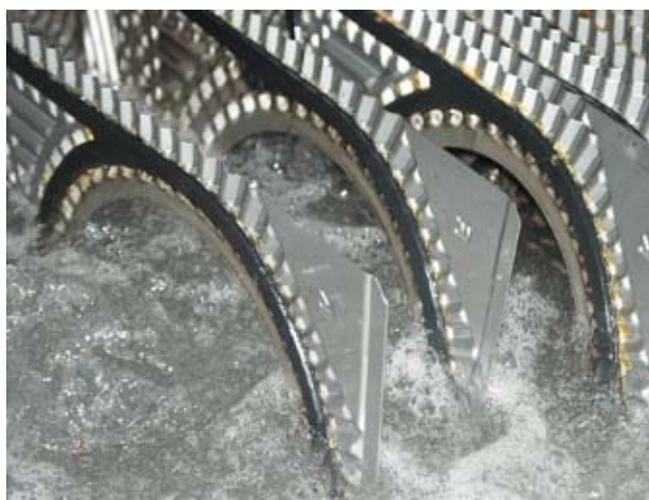
*Нагрев и турбулентность (благодаря воздушным пузырькам) способствуют более эффективной очистке.*
