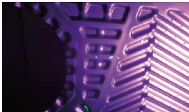
Иногда приходится проводить цветную дефектоскопию швов на всей поверхности в зависимости от материала пластин и области применения.
