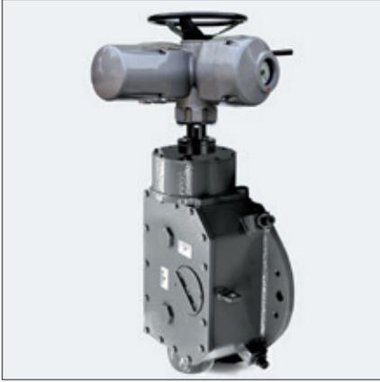
Редуктор с треугольным шатуном для установки на клапанах, требующих высокого крутящего момента в конце ходов (открыто/закрыто). Также могут использоваться на кранах, закрывающихся при повороте на четверть оборота, когда необходим высокий крутящий момент.
