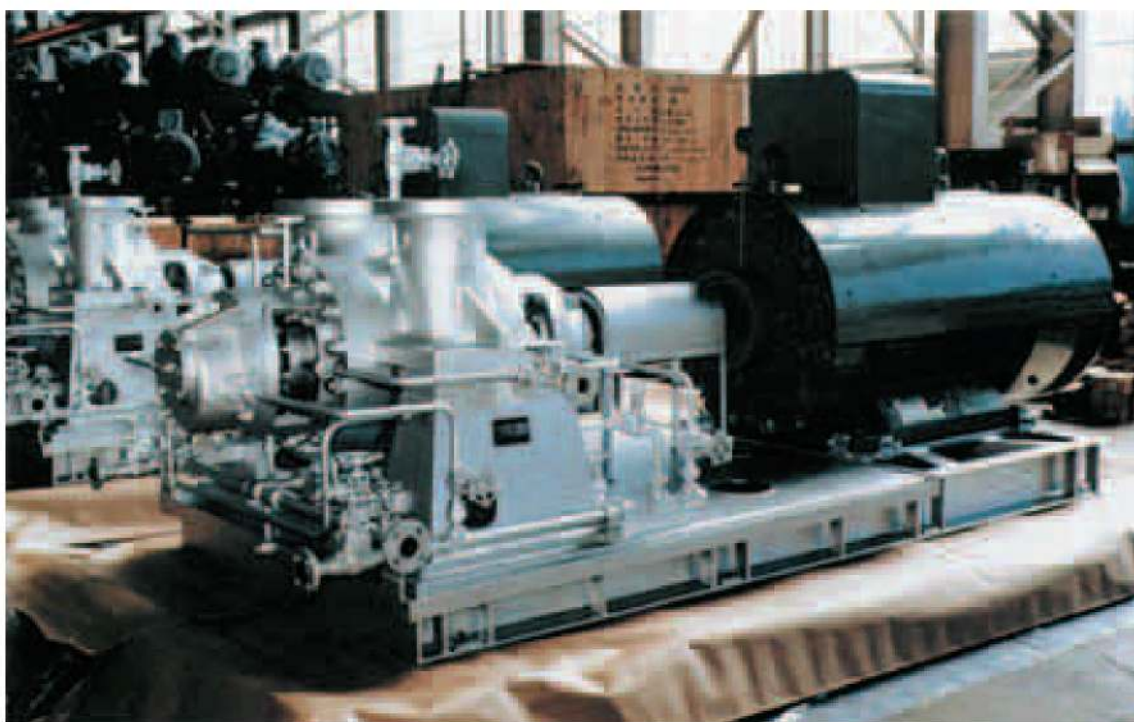
Колодезный насос для SINOPEC, Китай (модель R2)
