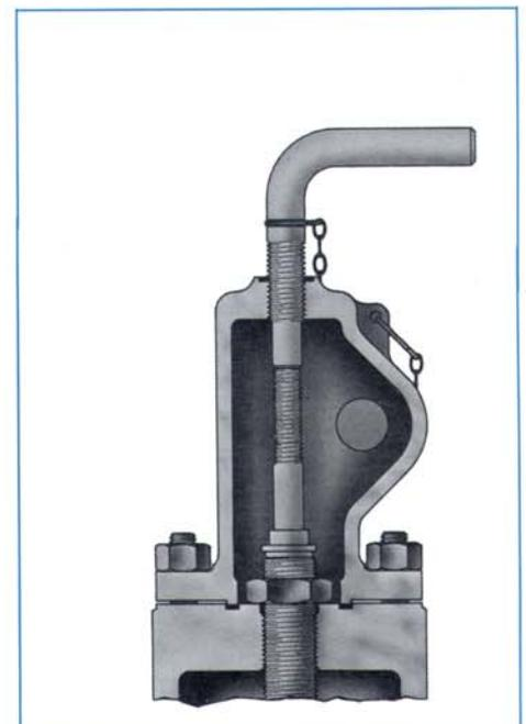
**Cappuccio con vite di blocco**
