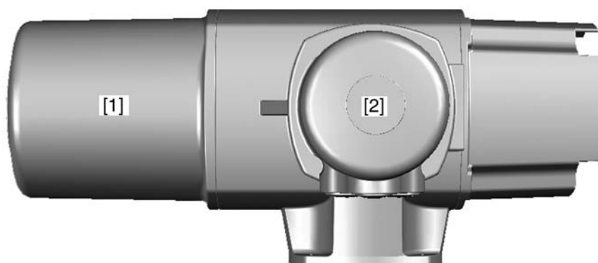
рис. 54: Доступ к предохранителям
