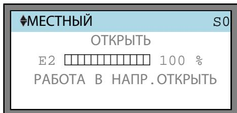
**Индикация исполнительной команды управления и уставки** В строке 2 показана текущая команда управления (ОТКР., СТОП, ЗАКР.) и текущее значение уставки E1 или E7 (на приводах с позиционером или контроллером процессов) в % от всего участка хода.
