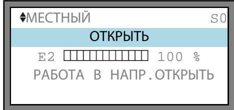
**Индикация положения арматуры** В строке 3 отображается положение арматуры в процентах от всего участка хода. Показания этого параметра отображаются только, если на приводе установлен датчик указателя положения.
