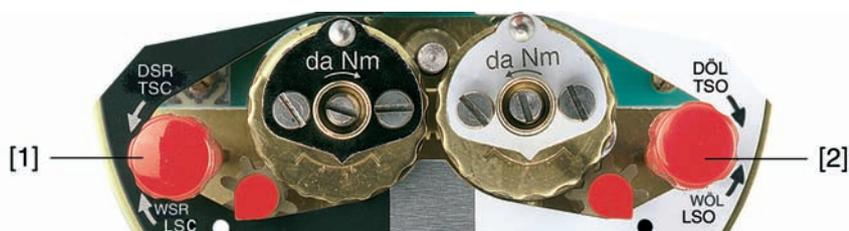
1. Ручку [1] повернуть в направлении стрелки MBЗ: срабатывает моментный выключатель направления ЗАКРЫТЬ.
