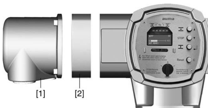
[1] Электрическое подключение
