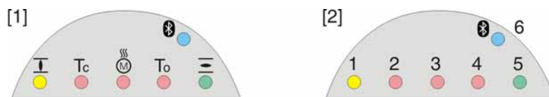
рис. 67: Расположение ламп и описание ламповой индикации
