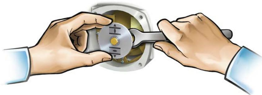
2. По таблице проверьте соответствие количества оборотов на ход электропривода настройке согласующего редуктора (пункты 1—9).
