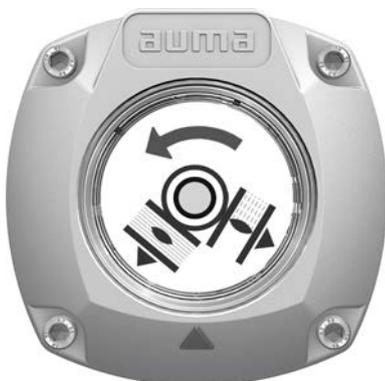
Механический указатель положения показывает положение арматуры с помощью двух дисков с символами  $\square$  (ОТКРЫТО) и  $\square$  (ЗАКРЫТО). При правильной настройке символы ОТКРЫТО/ЗАКРЫТО в конечных положениях находятся напротив метки  $\blacktriangle$  на крышке.
