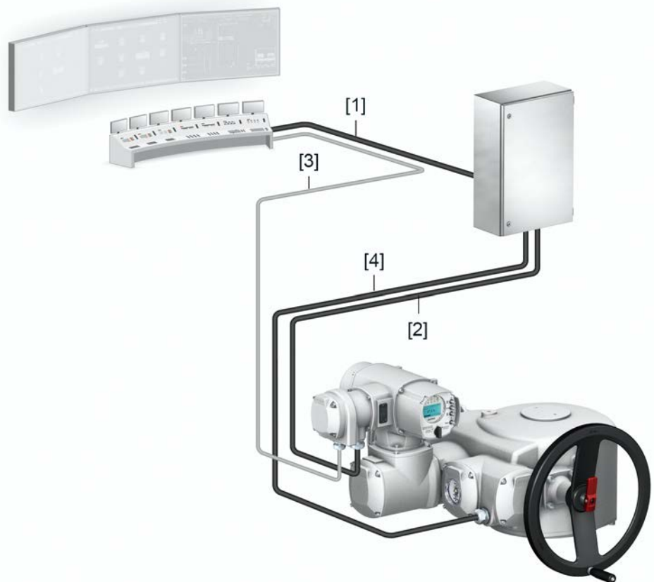
Рис. 41: Пример прокладки кабеля к блоку управления электроприводом с распределительной коробкой
