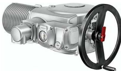
Многооборотные приводы SA 25.1 – SA 48.1/SAR 25.1 – SAR 30.1 компании AUMA работают от электродвигателей. Соединительная муфта А выдерживает осевую нагрузку. Для ручного управления предусмотрен маховик. Отключение в конечных положениях осуществляется концевыми выключателями или моментными выключателями. Для управления и обработки сигнала привода требуется блок управления.
