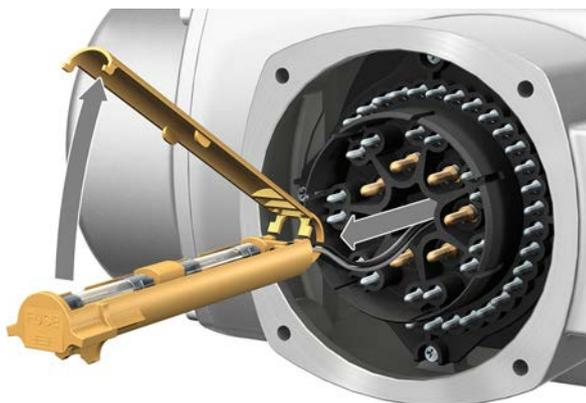
2. Вытащить держатель предохранителей из колодки, открыть крышку и заменить предохранители.
