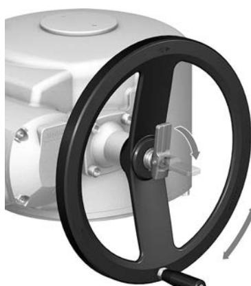
2. Отпустить рычаг переключения, который, благодаря пружине, вернется в исходной положение. В противном случае помочь рукой.
