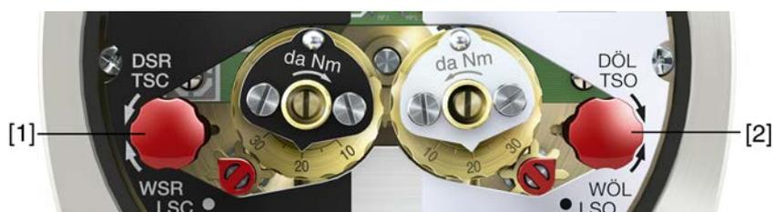
1. Ручку [1] повернуть в направлении стрелки DSR: срабатывает моментный выключатель направления ЗАКРЫТЬ.
