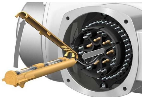
2. Вытащить держатель предохранителей из колодки, открыть крышку и заменить предохранители.
