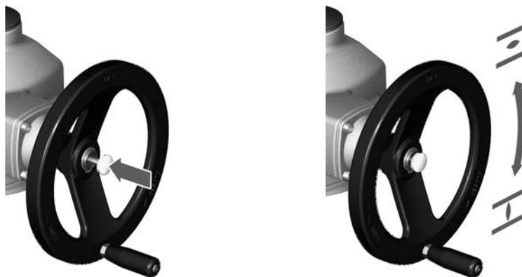
➔ Направление закрытия обозначено на маховике:
