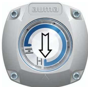
Механический указатель положения с автоматической настройкой показывает положение арматуры с помощью стрелки  $\Rightarrow$ . При правильной настройке стрелка в конечных положениях указывает на символ  $\ominus$  (ОТКРЫТО) или  $\oplus$  (ЗАКРЫТО).
