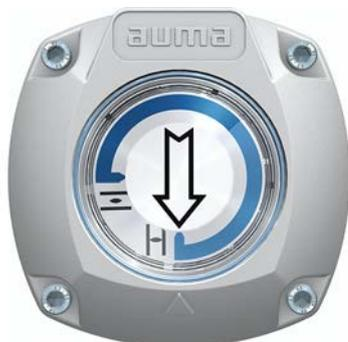
В исполнении с механическим указателем положения с автоматической настройкой данный указатель настраивается автоматически при первом перемещении арматуры (например, из положения ЗАКРЫТО в положение ОТКРЫТО). Как правило, автоматическая настройка происходит уже при настройке отключения по положению (при перемещении арматуры в конечные положения). Поэтому ручная настройка и, следовательно, открытие отсека выключателей при вводе в эксплуатацию не требуется.
