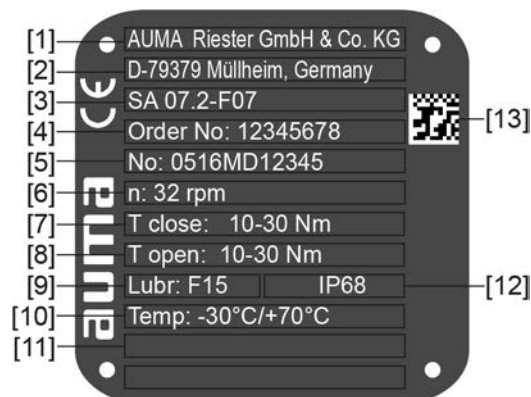
Рис.2: Заводская табличка электропривода (пример)
