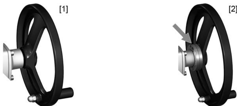
Рис.32: Маховик с защитой / без защиты от перегрузки
