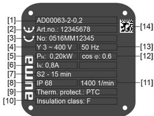
Рис.4: Заводская табличка двигателя (пример)
