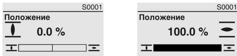
Рис.47: Достигнуто конечное положение ОТКРЫТО/ЗАКРЫТО
