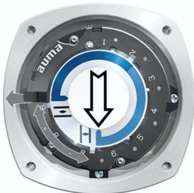
рис. 72: Настройка согласующего редуктора
