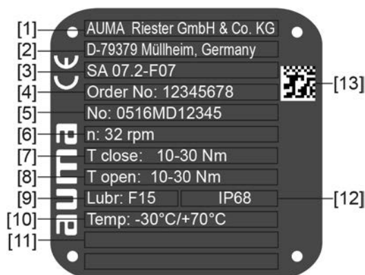
рис. 2: Заводская табличка электропривода (пример)
