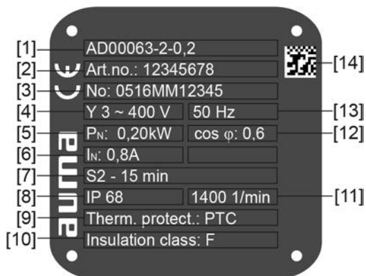
рис. 4: Заводская табличка двигателя (пример)
