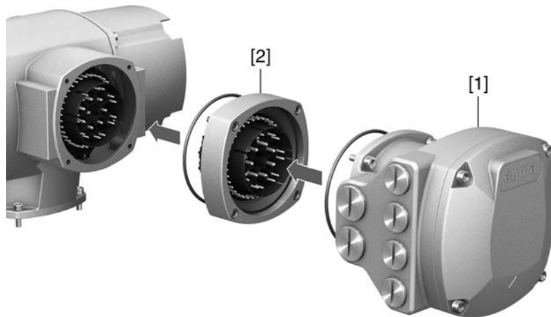
Рис. 29: Электрическое подключение с промежуточной рамкой
