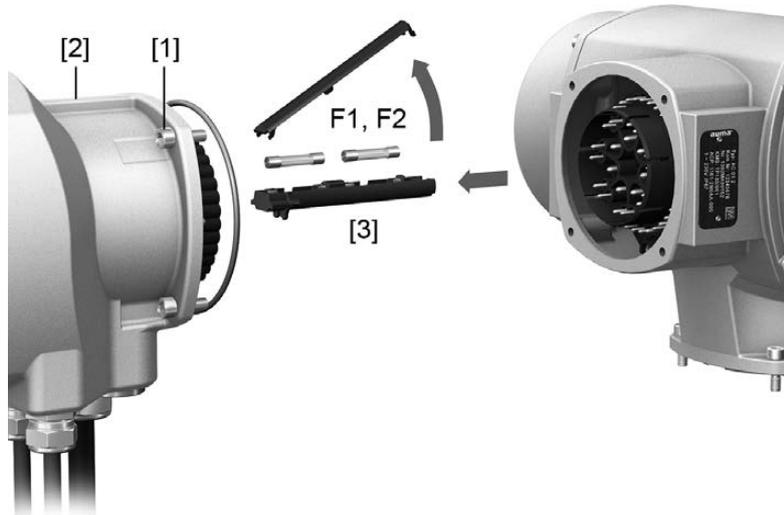
2. Вытащить держатель предохранителей [3] из колодки, открыть крышку и заменить предохранители.
