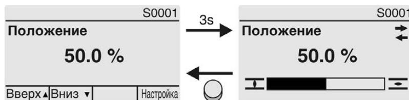
При достижении установленных конечных положений дополнительно отображаются значки **┌** (ЗАКРЫТО) и **┐** (ОТКРЫТО).
