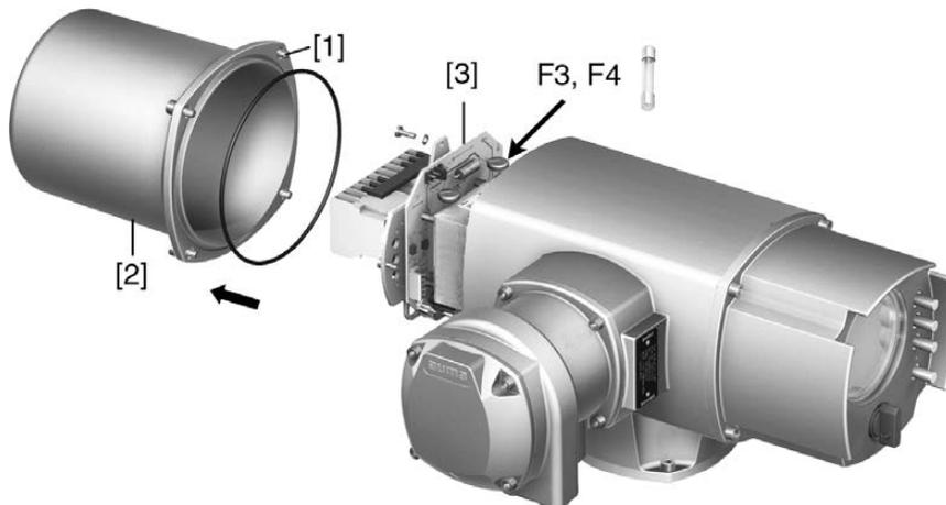
На блоке питания имеются измерительные контакты (с возможностью пайки), с помощью которых можно провести измерение сопротивления.
