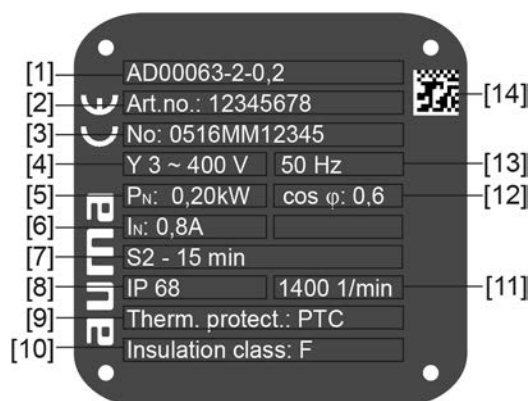
рис. 4: Заводская табличка двигателя (пример)
