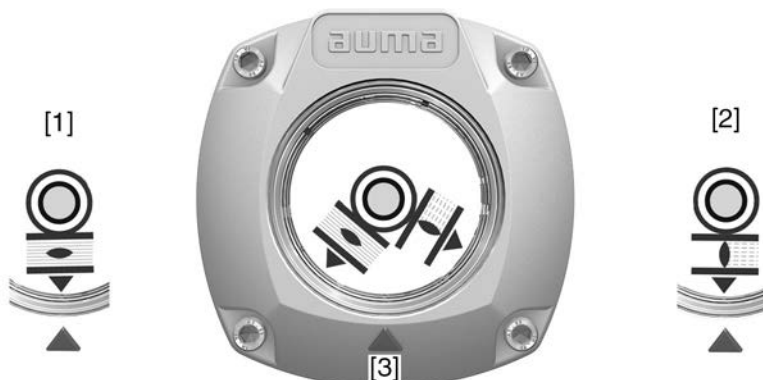
рис. 26: Механическая индикация положения с помощью метки на крышке
