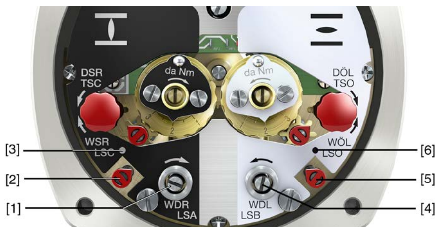
рис. 35: Регулировочные элементы концевого выключателя
