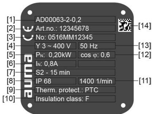
рис. 3: Заводская табличка двигателя (пример)
