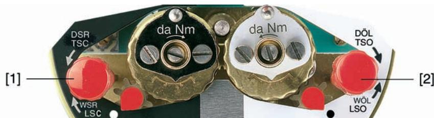
1. Ручку [1] повернуть в направлении стрелки MB3: срабатывает моментный выключатель направления ЗАКРЫТЬ.
