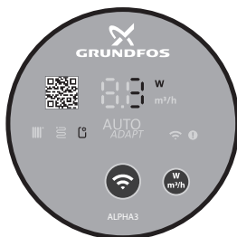
Рис. 20 Панель управления в режиме пропорционального давления
