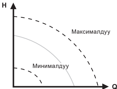
16-сүр. Соркысманын чыгымдык-кысымдык мүнөздөмөлөрүнүн максималдык жана минималдык ийри сызыгы.
