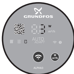
20-сүр. Катыштык басым шарттамында башкаруу панели
