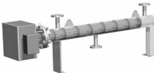
Исполнение Ex'e' с кольцевыми диафрагмами стержневого типа для минимизации падения давления полного потока
