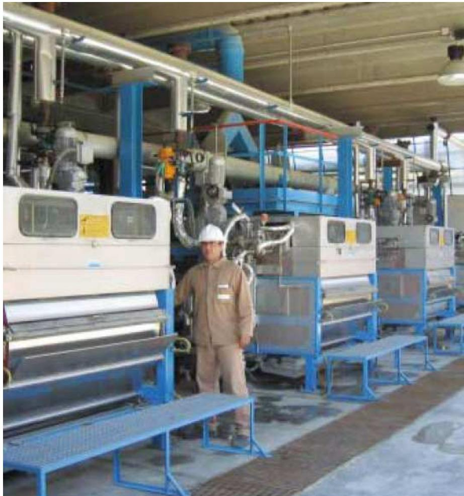
Установки Rotoform на заводе грануляции серы на Сицилии
