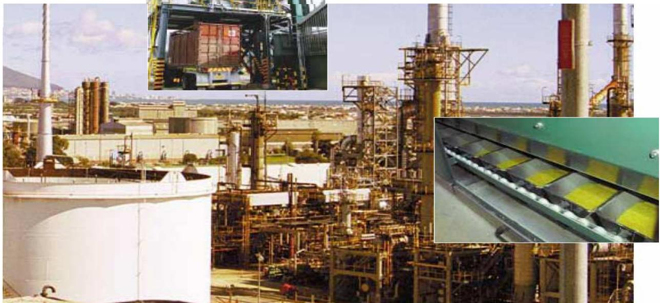
При работе 24 часа в сутки и производительности до 12 тонн в час эта установка может обрабатывать до 288 тонн серы в день.
