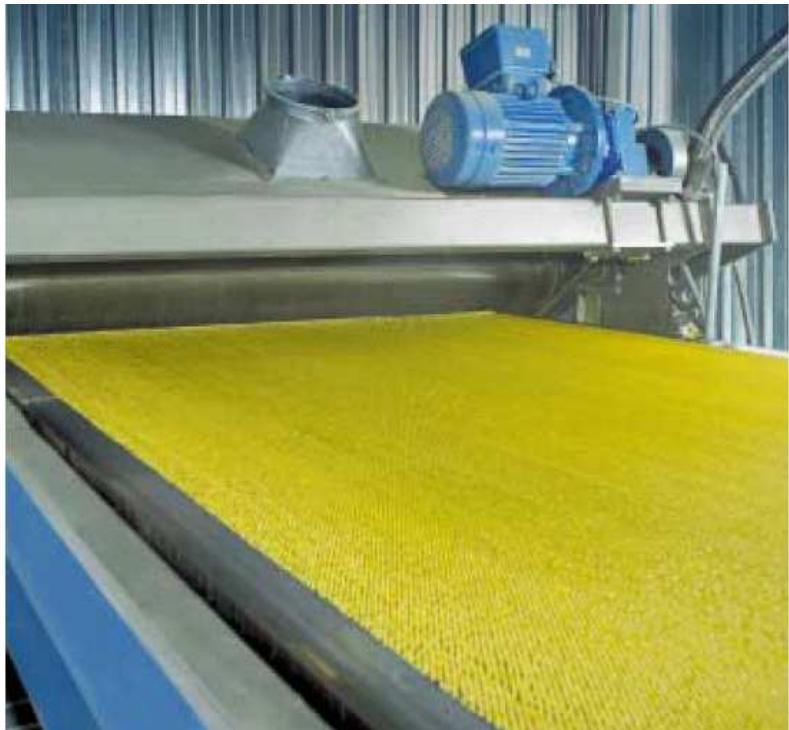
Rotoform HS – подача капель серы на стальную ленту конвейера-охладителя
