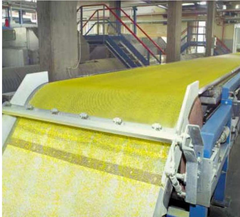
Установка Rotoform – разгрузочный узел
