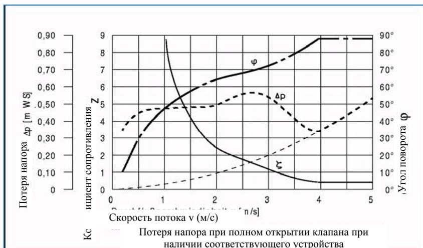
Межевая кривая обратного клапана ERHARD DN 500, PN 10, с рычагом и противовесом при монтаже в горизонтальный трубопровод.
