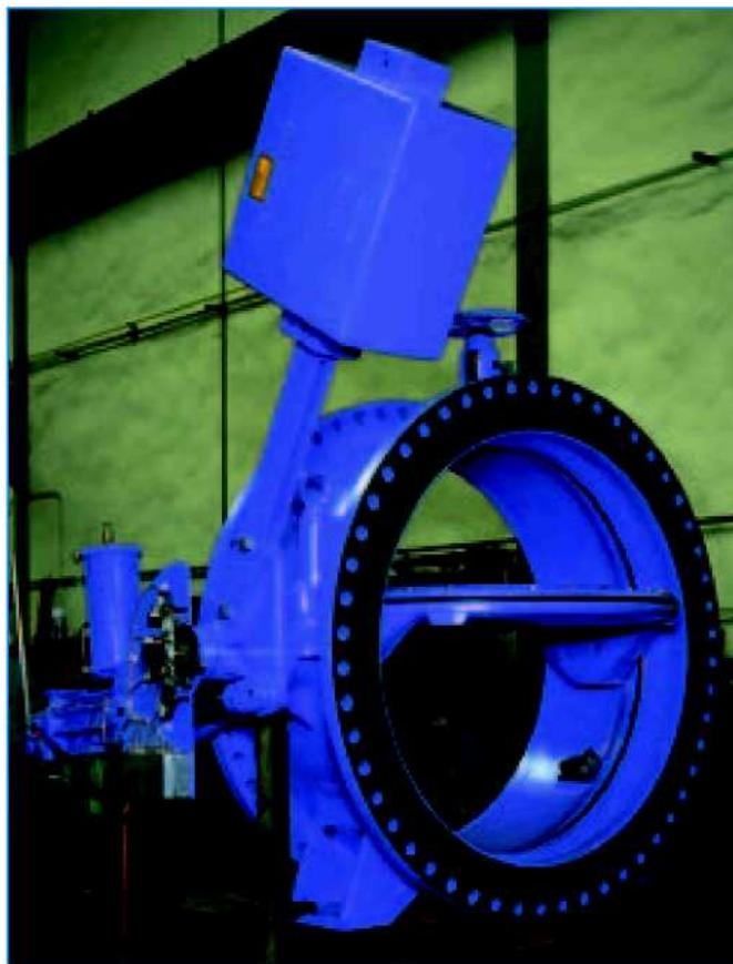
Поворотно-дисковый клапан ERHARD DN 1600 с блокировочным устройством и с гидроприводом и противовесом для электростанции в Португалии
