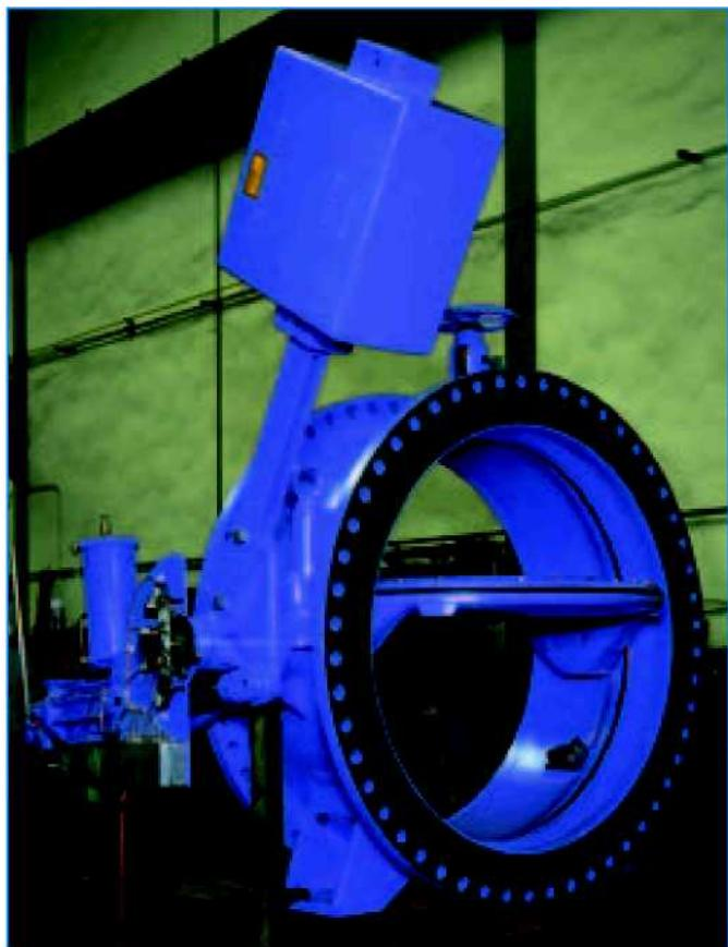
Поворотно-дисковый клапан ERHARD DN 1600 с блокировочным устройством и гидроприводом и противовесом для электростанции в Португалии
