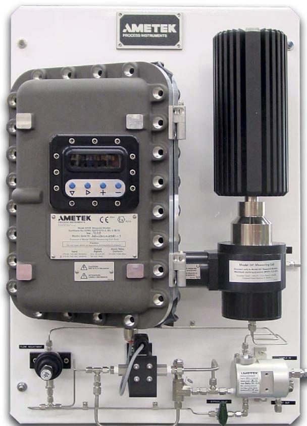
На встроенный дисплей кроме значения точки росы по углеводородам выводится информация о последнем значении измеренной температуры точки росы, рабочем давлении внутри измерительной ячейки (при наличии датчика), продолжительности работы монитора, диагностика состояния работы монитора и другая служебная информация. Имеются токовые выходы 4...20 мА для непрерывной регистрации измеренной точки росы и условного кода состояния.
