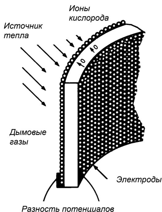
Напряжение в ячейке зависит от температуры, поэтому она поддерживается постоянной специальной системой нагрева и регулирования.
