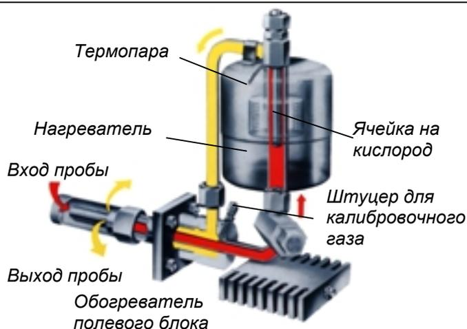
За счет нагревателя ячейки и дополнительного нагревателя зонда температура газа в зонде и тракте полевого блока всегда выше температуры точки росы пробы. Это очень важно при анализе влажных газов.
