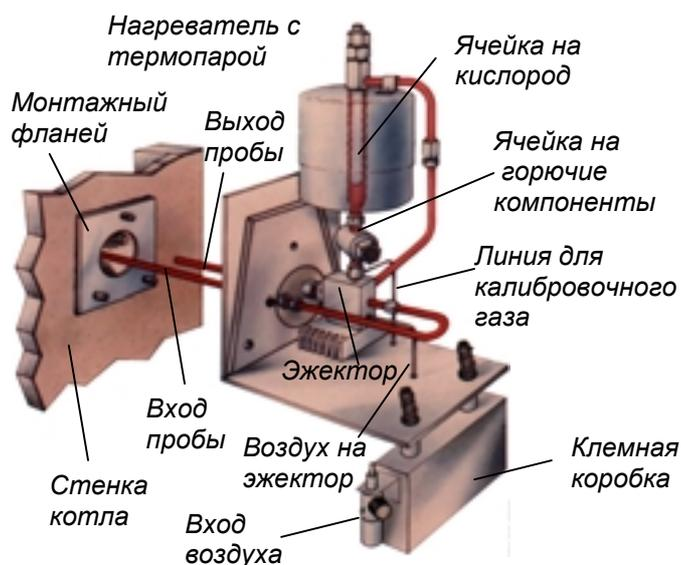
Анализаторы **WDG-IV** предназначены для влажных газов в системах регулирования установок на газомазутном топливе. Необходимый при этом быстрый отклик достигается принудительным продвижением пробы через зонд.
