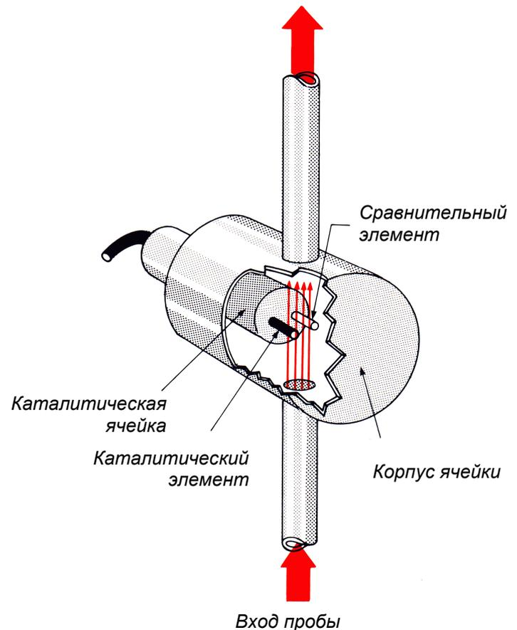
Такие ячейки способны измерять концентрацию горючих компонентов в диапазоне ppm, если используются тонкопленочные резисторы с лазерной обработкой и компьютерным согласованием температурных коэффициентов. При этом необходимо, чтобы температура корпуса и газового потока поддерживалась достаточно стабильной.
