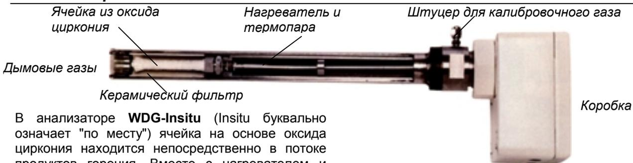
В анализаторе **WDG-Insitu** (Insitu буквально означает "по месту") ячейка на основе оксида циркония находится непосредственно в потоке продуктов горения. Вместе с нагревателем и термопарой она располагается на конце зонда, который установлен в технологическом потоке.
