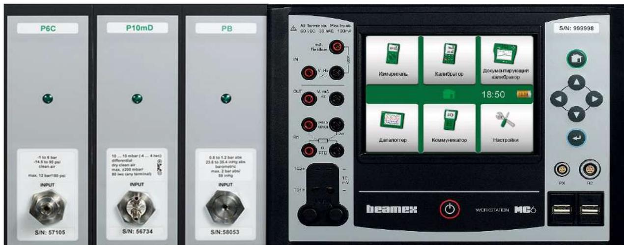
Измерение и задание давления и электрических сигналов
