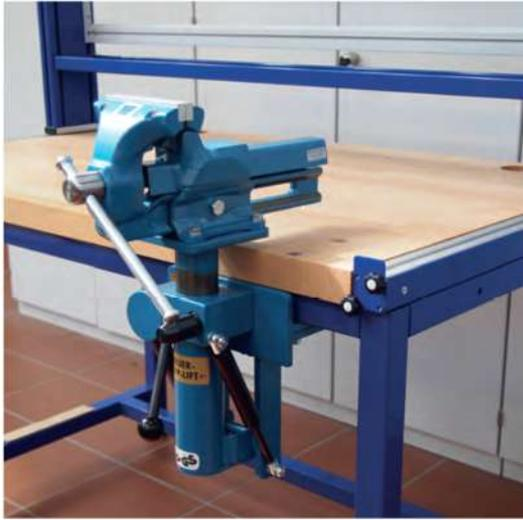
Тиски можно сложить ниже столешницы, когда не используются. В рабочем положении регулируется высота (около 175 мм) и поворот на 360°.
