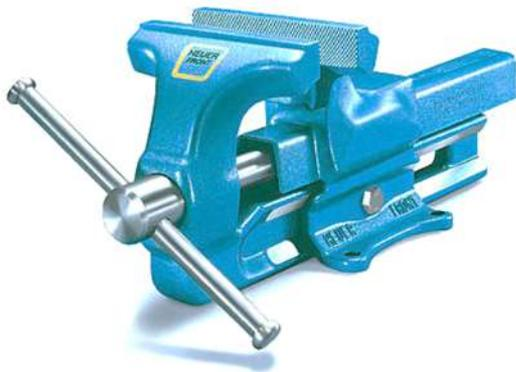
Тиски HEUER с коваными зажимными губками и губками для труб, с широким раствором, точный и легкий ход направляющей рейки, высокая точность подшипника ходового винта с двухзаходной трапецидальной резьбой, рифленые сменные зажимные губки.
