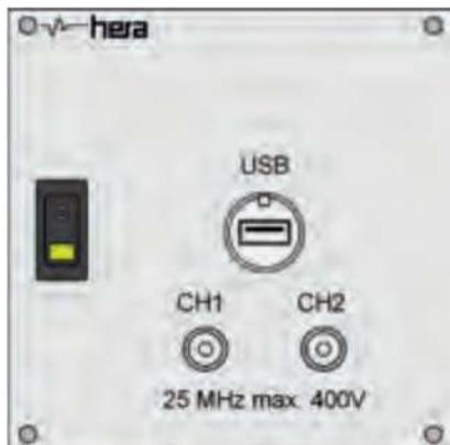
2-канальный компьютерный осциллограф со встроенным интерфейсом для прямой связи с ПК с помощью прилагаемого ПО
