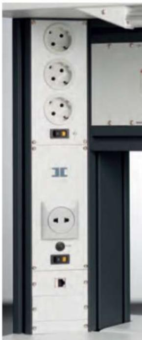
Профиль **Multimedia**, задняя сторона которого состоит из прямого компактного терминала, предназначен для установки модулей **КК** (высота 70 мм): автоматы питания, розетки, разъемы RS232, RJ45, DVI, USB и др., длина: 500 - 2303 мм
