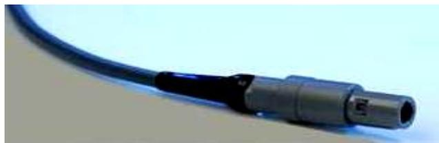
Сохранение индивидуальной калибровки STS200 в ПЗУ, размещенном в разъеме кабеля самого термометра, позволяет быстро включать в работу STS200, исключая загрузку данных термометра в калибратор и возможные ошибки оператора.
