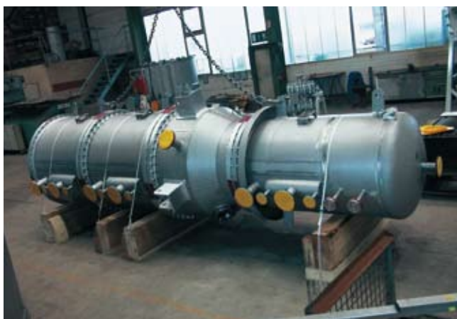
трехступенчатый верхний конденсатор
