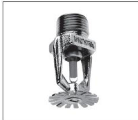
Спринклеры стандартного срабатывания Viking могут быть заказаны и/или использованы в качестве дренчеров (без стеклянной колбы и седла) в затопительных системах. См. Инструкцию по Заказу на странице 11b.
