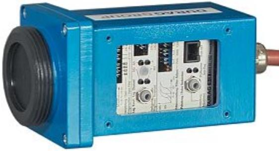
Оптический датчик пламени D-LE 703 с жестким (D-LL 704) или гибким (D-LL 703) световодом является устройством, обеспечивающим безопасность процесса и предназначен для контроля горения газообразного, жидкого и твердого топлива непосредственно в горячей зоне горелки. Может комплектоваться УФ или ИК сенсорами нескольких типов. Обладает встроенными средствами самодиагностики и блокировки при отказе.
