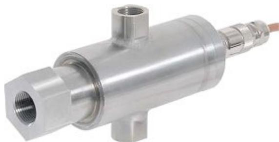
Оптический датчик пламени D-GT 800 является устройством, обеспечивающим безопасность процесса и предназначен для контроля горения газообразного, жидкого и твердого топлива в особо неблагоприятных условиях окружающей среды. Может комплектоваться четырьмя типами УФ сенсоров. Обладает встроенными средствами самодиагностики и блокировки при отказе.
