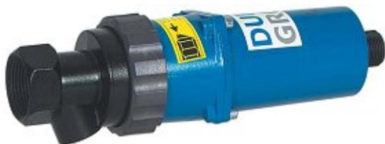
Оптический датчик пламени D-LE 103 является устройством, обеспечивающим безопасность процесса и предназначен для контроля горения газообразного, жидкого и твердого топлива преимущественно в одnogорелочных агрегатах.
