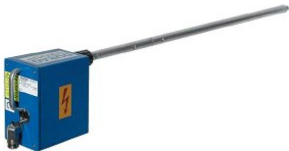
Запальное устройство D-HG 400 предназначено для розжига газовых и мазутных горелок любой мощности. Устройство содержит трансформатор, высоковольтный конденсатор и твердотельный электронный ключ.
