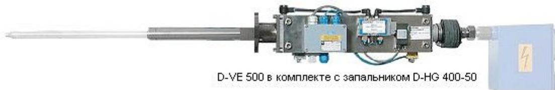
Пневматическое подающее устройство D-VE 500 предназначено для подачи и точного позиционирования запальной пики в камере сгорания для надежного розжига горючей смеси. После розжига запальная пика выводится из камеры сгорания для предохранения устройства от воздействия высокой температуры и агрессивной среды.
