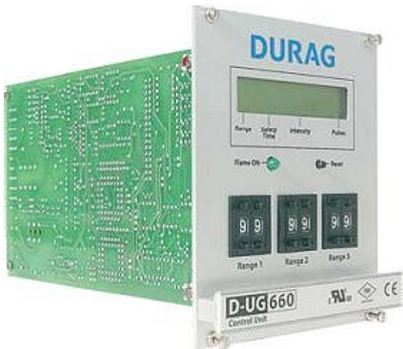
Блок управления D-UG 660 является устройством, обеспечивающим безопасность процесса и предназначен для преобразования сигналов от датчиков пламени. Обладает встроенными средствами самодиагностики и блокировки при отказе. Применяется совместно с датчиками:
